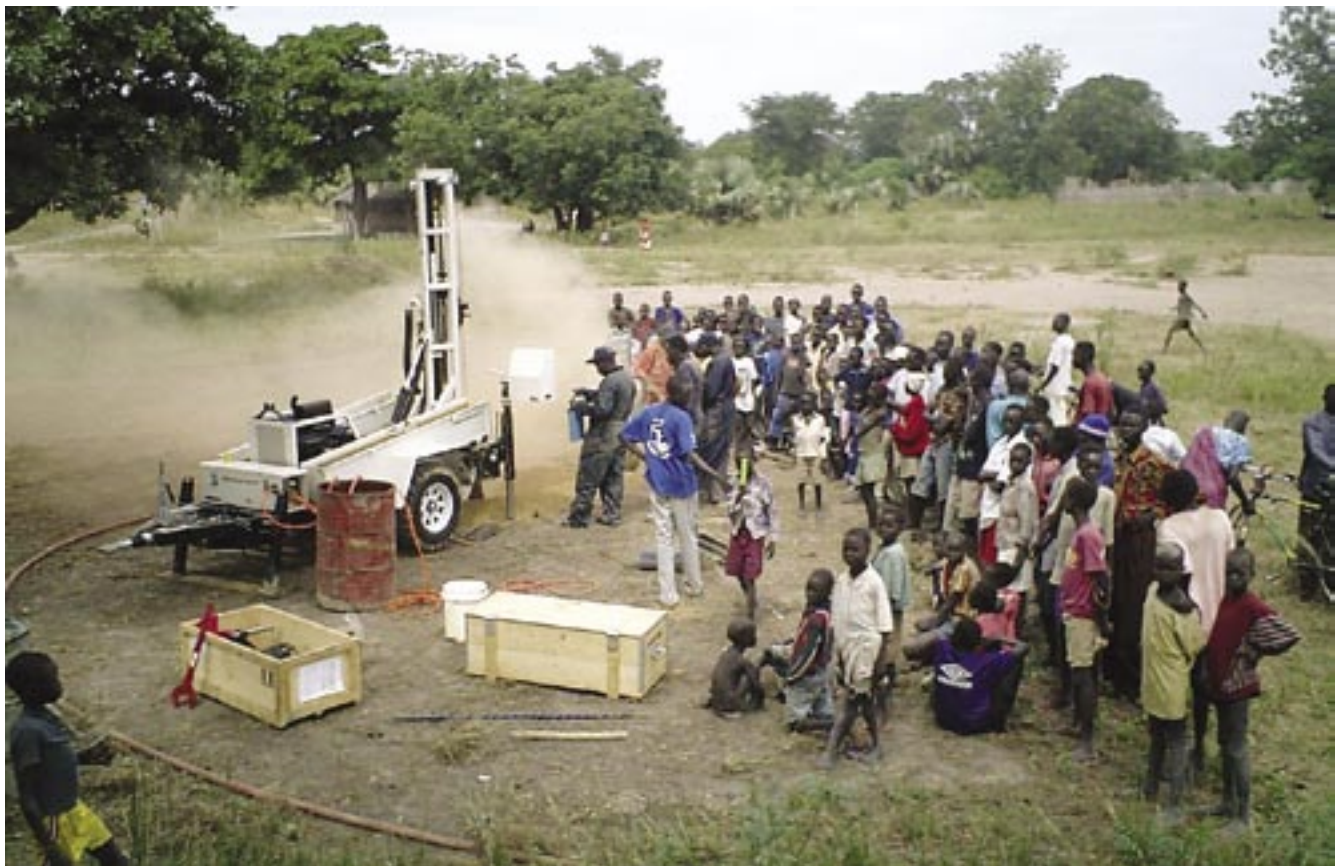
Un atelier de forage portable équipé de DHT
